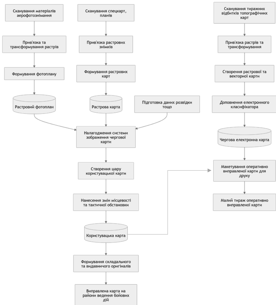
Рисунок 1 – Удосконалена технологічна схема створення карти змін місцевості із застосуванням інструментальної ГІС
