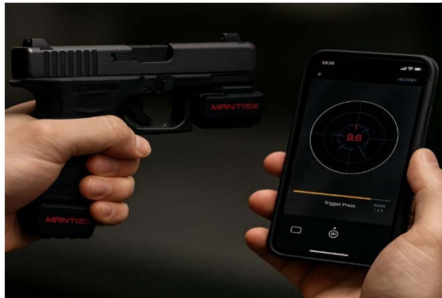
Рисунок 4 - Цифрова система MantisX для оцінювання бойової ефективності короткоствольної стрілецької зброї за допомогою мобільного додатку [8]
